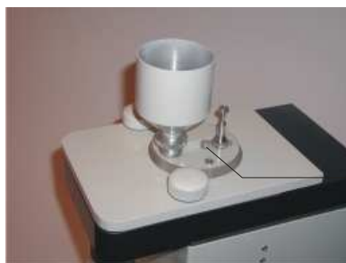
Рис. 7 Переустановка автоматического дозатора в ручной режим
