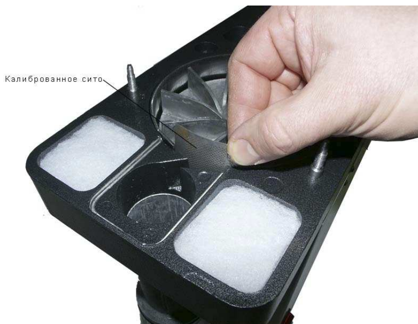
Рис 8. Установка и замена калиброванного сита
