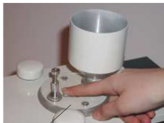
Рис. 5 Очистка камеры дозатора
