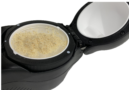
Малюнок 5. Розміщення розмеленого зразка на склі аналізатора GrainSense
