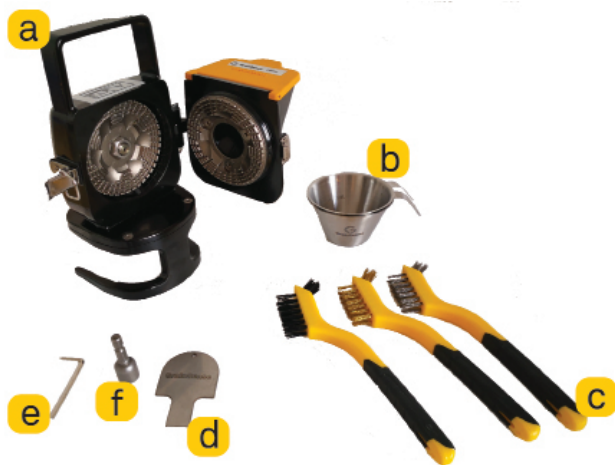
Малюнок 1. Портативний польовий млин GrainSense та відповідні аксесуари
