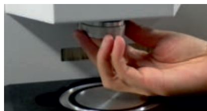
Самостійна заміна джерела світла без необхідності перекалібрування
