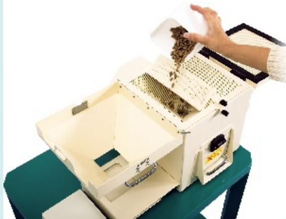
Для работы NHP100 необходимо загрузить предварительно очищенный и взвешенный образец в воронку для испытаний.
