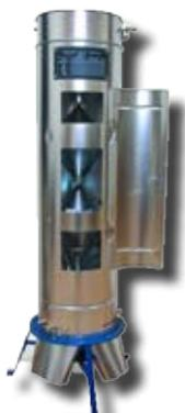
Делитель проб зерна
